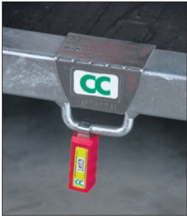
RFID-chip verwerkt in een trolley van Baas Plantenservice. (Foto: Luc Hommes).
