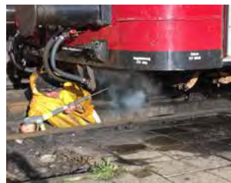
Ook de onderzijde wordt schoongehouden. Hier wordt de Railbus met de hogedrukreiniger schoongespoot op het aspuitspoor.
